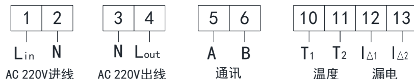
ASCP200-1 型限流式保护器接线端子图
