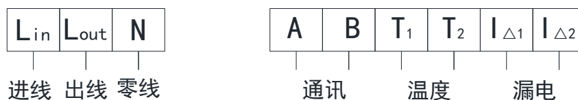
ASCP200-63D 限流式保护器接线端子图
