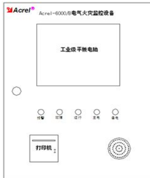
图 1 监控设备面板示意图
